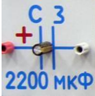
Модуль з конденсатором С3 Номинал: 2200 мкФ
