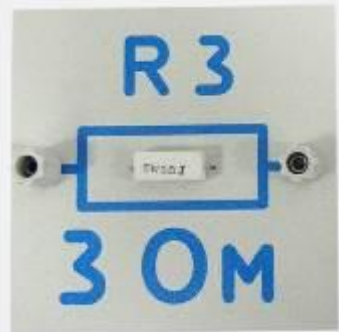
Модуль з резистором R3 Номінал: 3 Ом
