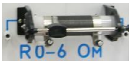
Модуль з реостатом Номинал: 0-6 Ом
