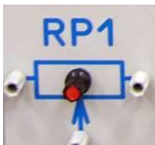
Модуль з потенціометром RP1 Номинал: 1 кОм
