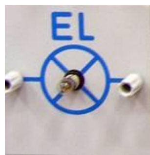
Модуль з лампою розжарювання Номинал: 6,3В; 0,3А
