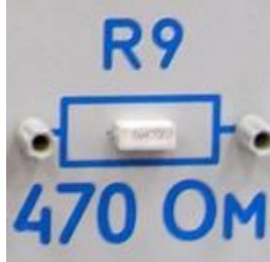
Модуль з резистором R9 Номинал: 470 Ом
