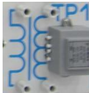
Модуль з трансформатором TP1 Номинал: 36/6 В
