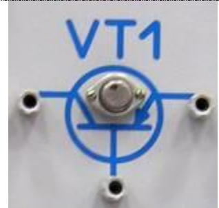
Модуль з транзистором VT1 Номинал: p-n-p, Ge
