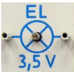
Модуль з лампою розжарювання Номинал: 3,5В; 0,26А
